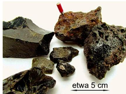
Wenn bei einer solchen steinähnlichen Schlacke ein kleiner Magnet (rot) festgehalten wird, heißt das: in der Schlacke muss ein magnetisierbarer Stoff eingeschlossen sein, nämlich Eisen vom Hüttenwerk!
