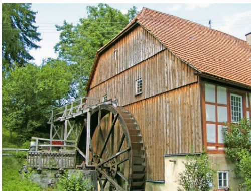
Wasserrad der Meuschenmühle im Schwäbischen Wald mit einem ober-schlächtigen Rad von über 7 m Durchmesser
