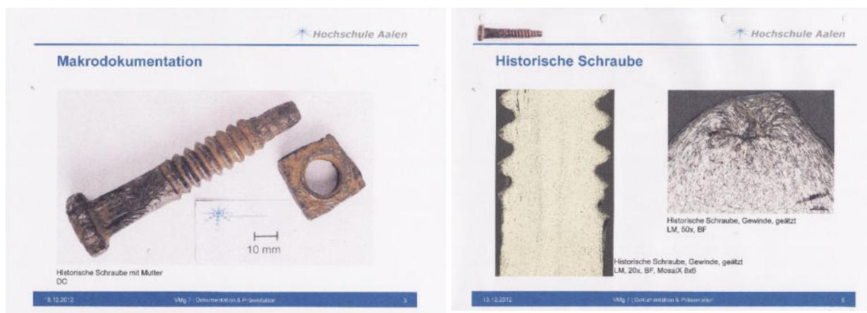
Bild 28 und 29 Untersuchung eines geschmiedeten Schraubengewindes
