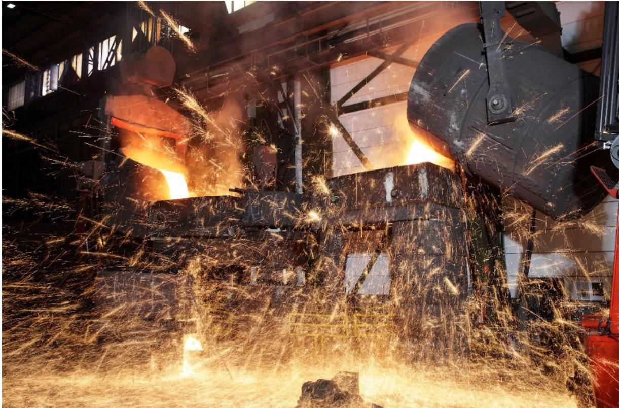
Bild 31 „Feuerwerk des Eisens“ – Gießprozess einer Hartgusswalze (SHW Archiv)
